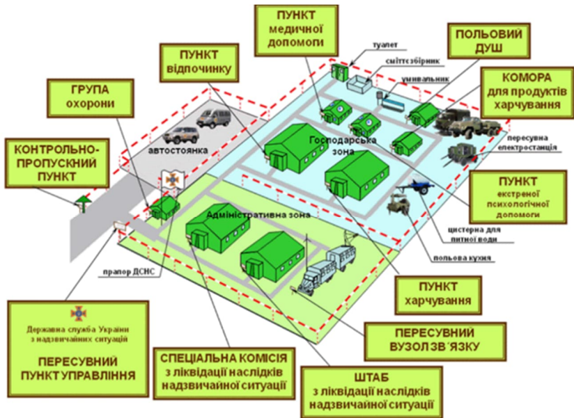
Мал. 5.1. Варіант схеми розгортання пересувного пункту управління
